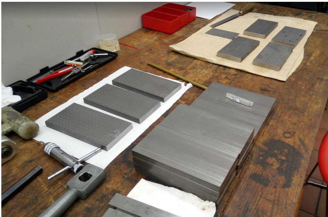
Fori da 1.2 mm ogni cm per uno spessore di 15 mm per ospitare le fibre (~ 400.000 per il prototipo finale!)
