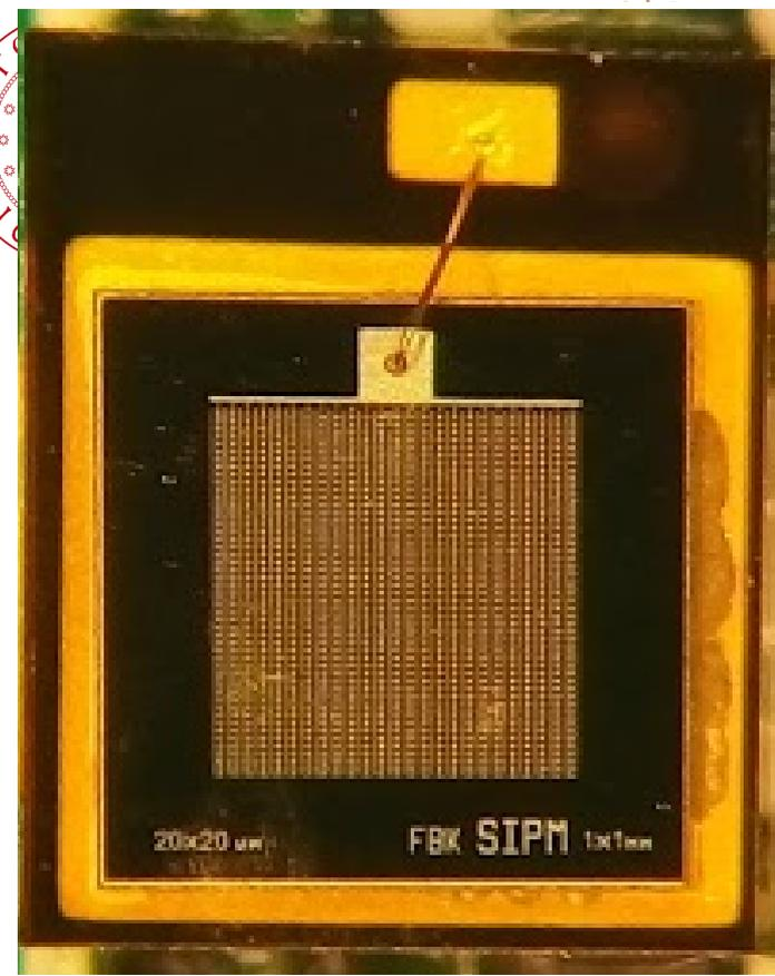
Ogni celletta e' (20x20 micrometri) e' un elemento di silicio che inizia a condurre corrente se colpito da un "grano di luce" (fotone)
